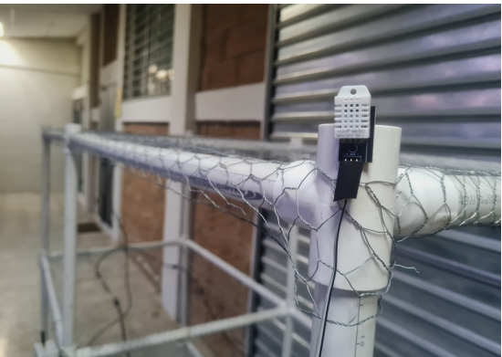
Figura 6. Ubicación de sensor DHT22 en la estructura
