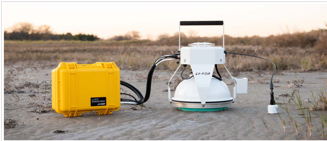
Figura 1. Carcasa del sensor y cámara de acumulación de CO 2 en suelos
