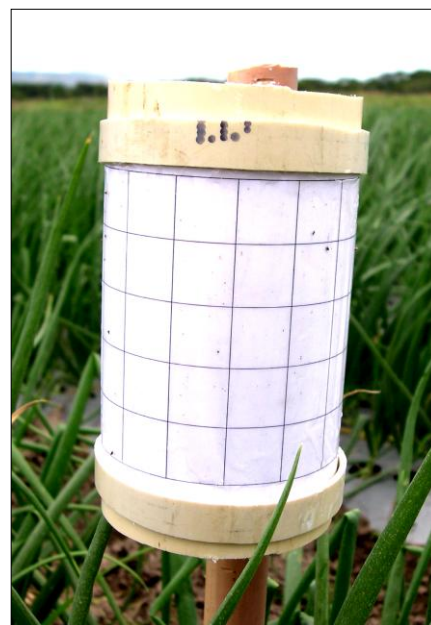
Figura 1. Trampa cilíndrica con tarjeta reticulada para el monitoreo de T. tabaci en cebolla.
